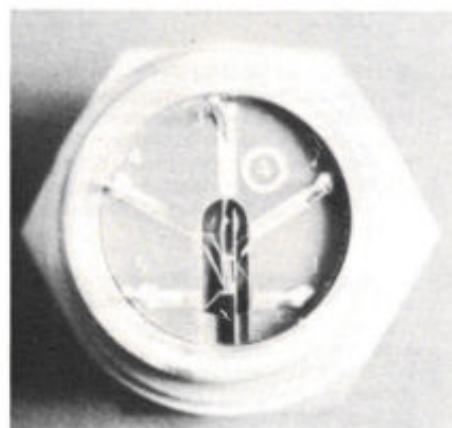
Afb. 2. Siliciumplaatjes met daarin aangebrachte rekstrookjes.
