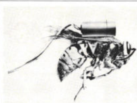
Afb. 5. Miniatuur-druktransducent (Entran Devices, Inc.).
