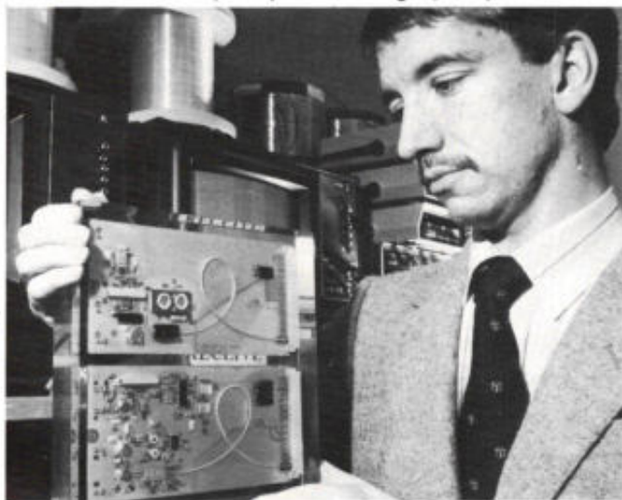
Afb. 2. De laserzender (boven) en de ontvanger (onder).
